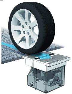
Das Messmodul selbst besteht aus einem Laser zur Beleuchtung des überfahrenden Reifens und einer Hochgeschwindigkeitsdigitalkamera, die das 3-D-Profil des Reifens aufnimmt und zur Verfügung stellt. Messwerte, die sowohl präventiver Belehrung als auch der Verfolgung von Ordnungswidrigkeiten dienen können.
